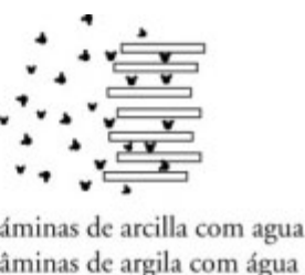
Fig. 3. Diagrama ilustrando como as argilas, lamínulas finas que tendem a se empilhar, se expandem na presença da água, pois esta penetra entre elas. Existem argilas, chamadas expansivas, que apresentam este fenômeno em um grau muito superior ao resto e, se estão presentes nos materiais, seja uma rocha ou uma argila, causam sua degradação.
