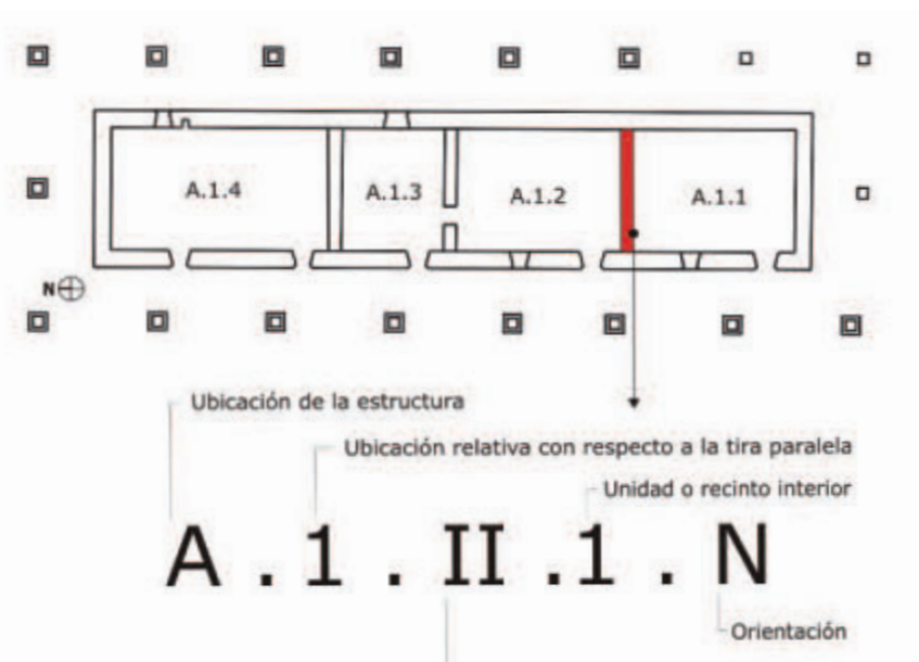
Figura 1. Ejemplo del esquema alfanumérico utilizado para la designación de estructuras.
