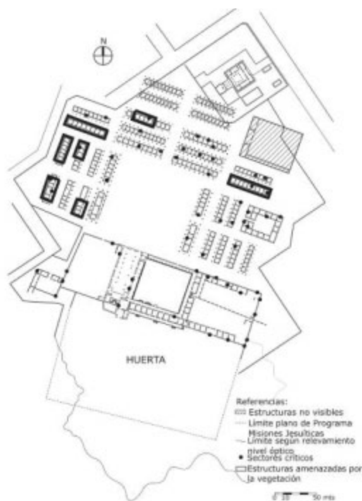
Figura 8. Mapa de riesgo estructural de San Ignacio Miní. Las zonas en riesgo estructural están marcadas con puntos o líneas negras.
