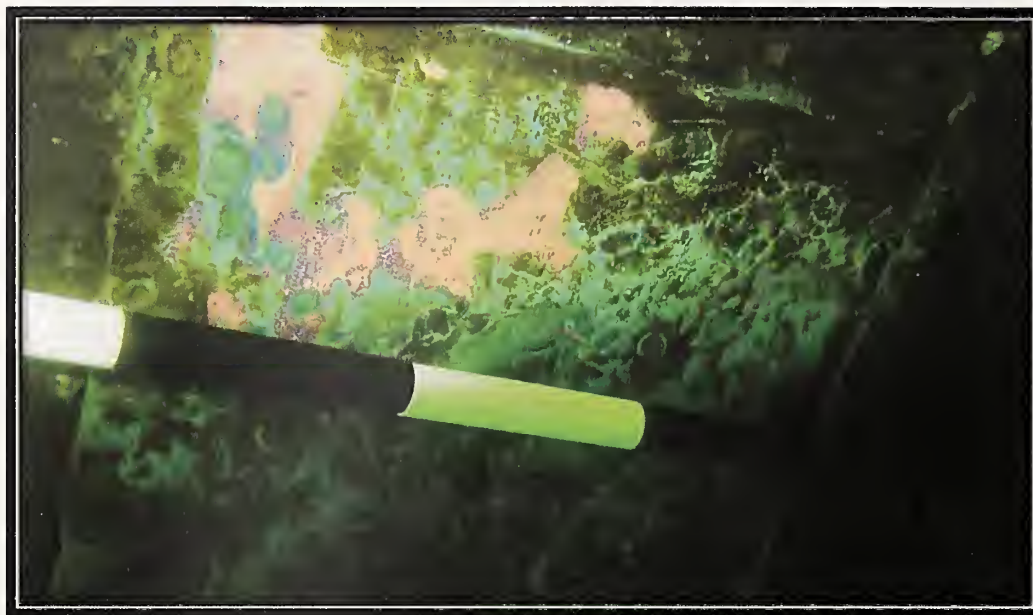
Photo 2 : Détail d'une plaque de cuivre recouvrant la coque du navire
