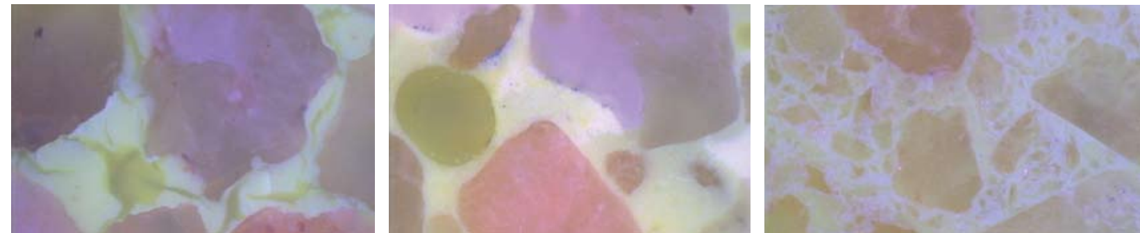
FOTOMICROGRAFÍA ÓPTICA DE UN MORTERO DE CAL CON UNA ARENA DE GRANULOMETRÍA UNIFORMEMENTE GRUESA (DE COLOR AZUL, CELESTY Y ROSADO). AL EVAPORAR EL AGUA DE LA PASTA DEL MORTERO, SE FORMAN GRANDES VACÍOS Y FISURAS (DE COLOR AMARILLO) EN LA PASTA DE CAL FRAGUADA (DE COLOR BLANCO). ESTO RESULTA EN UNA BUENA POROSIDAD INTERCONECTADA Y LA ABSORCIÓN DE AGUA POR CAPILARIDAD SERÁ GRANDE.
