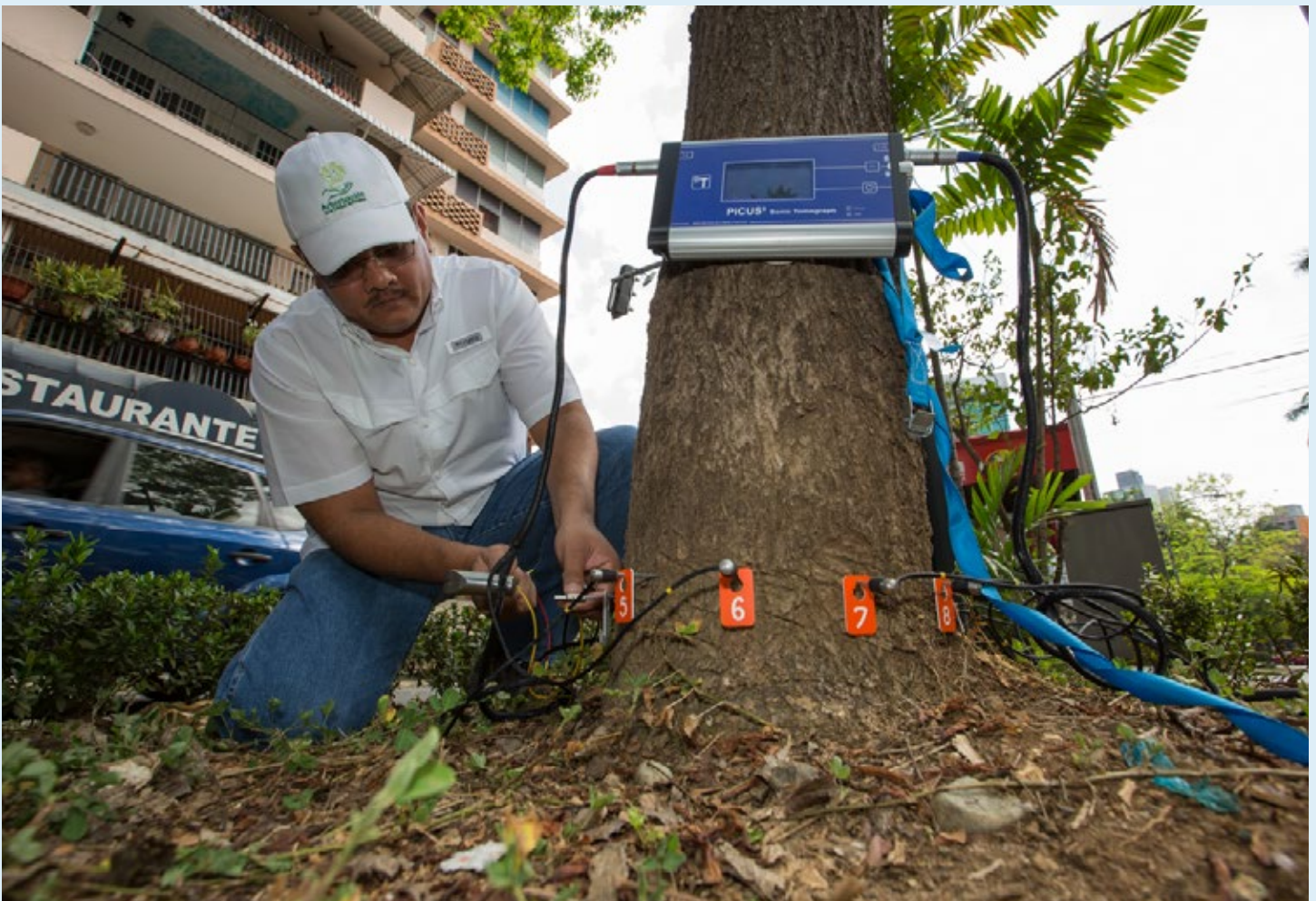
A municipal parks official scans a tree with sonic tomography on Panama City’s Via Argentina. | Un funcionario municipal escanea un árbol con tomografía sónica en la Ciudad de Panamá en vía Argentina. Photo by | Foto por: Sean Mattson, STRI
