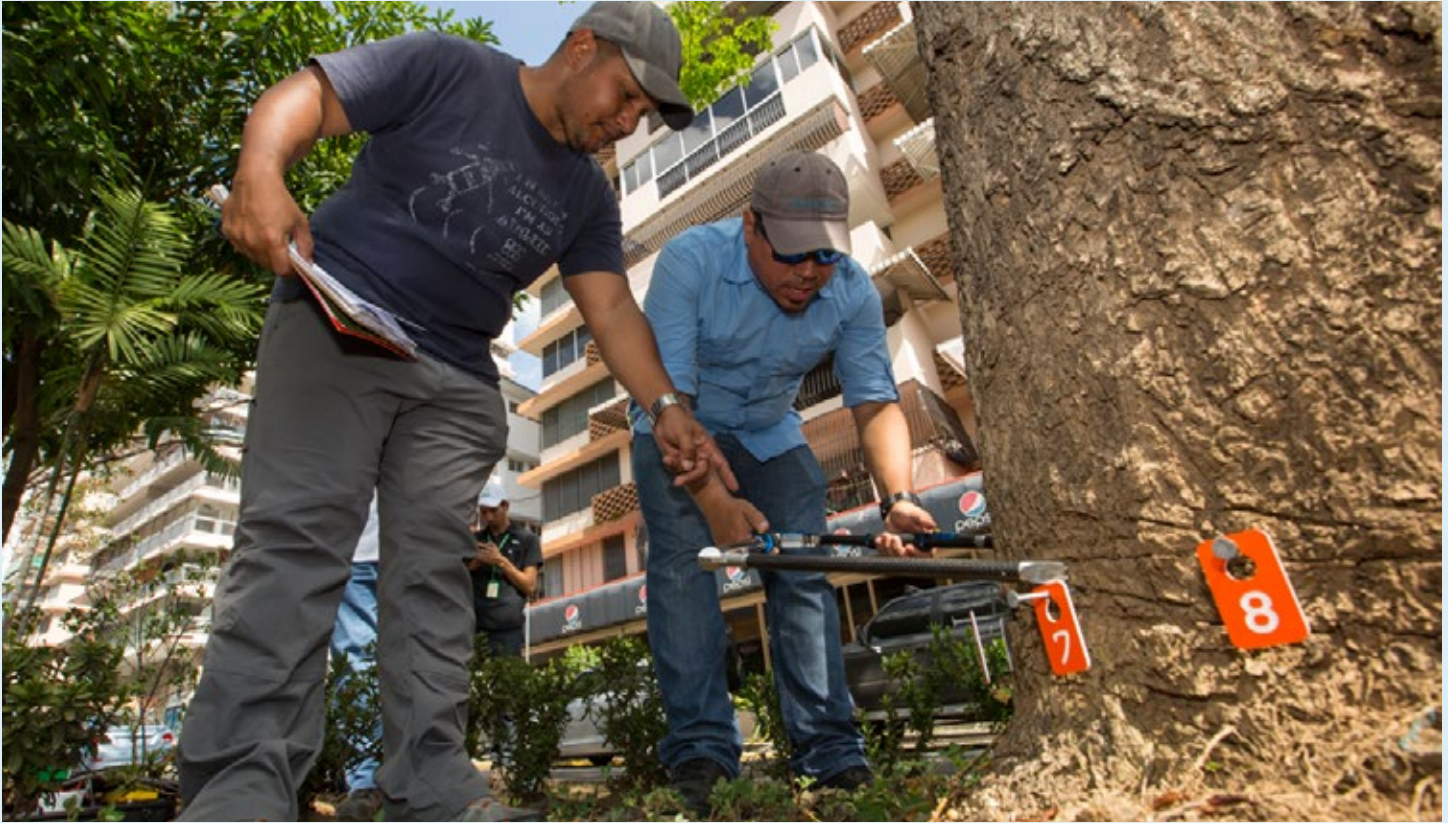
STRI's Javier Ballesteros trains municipal officials on how to use sonic tomography on trees along Panama City's Via Argentina. | Javier Ballesteros de STRI capacita a funcionarios municipales sobre cómo usar la tomografía sónica en los árboles a lo largo de la Ciudad de Panamá en Vía Argentina. Photo by | Foto por: Sean Mattson, STRI
