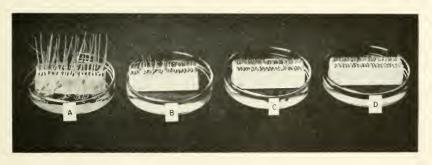
2. INHIBITION BY HYDROGEN PEROXIDE VAPOR
