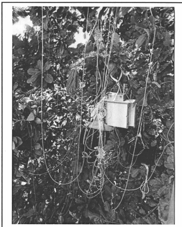
The STRI canopy tower allows scientists to set up studies of different aspects of the forest canopy with relative ease for the first time. Guillermo Goldstein and his team of scientists have set up dataloggers run by car batteries and a series of tubes and cables approximately 30 meters high in an Anacardium tree ••• La grúa del Smithsonian en el Parque Metropolitano permite a científicos estudiar diferentes aspectos del dosel del bosque por primera vez con relativa facilidad. Guillermo Goldstein y su equipo de científicos han montado un equipo sofisticado para tomar mediciones con una serie de tubos y cables, a aproximadamente 30 metros de altura en un árbol de Anacardium . (Foto: C. Hansen)
