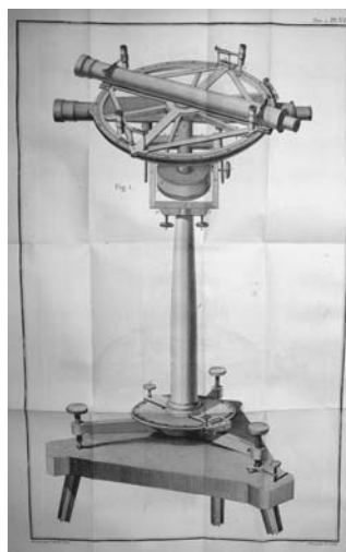
Borda repeating circle used by Mechain and Delambre, from Base du système métrique .
